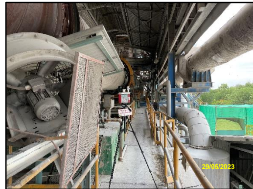
ภาพที่ 3.52 การตรวจวัดระดับความร้อนบริเวณ ทางเดินข้างแท่น 3 หม้อเผา 2
