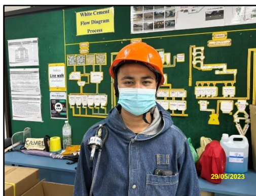
ภาพที่ 3.60 การตรวจวัดฝุ่นละอองในสถานที่ทำงานบริเวณหม้ออบ Pet Coke (พนักงานอาคารหม้ออบวัตถุดิบ)
